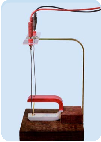
a) Üzerinden akım geçmeyen telin mıknatısın manyetik alanındaki denge durumu
