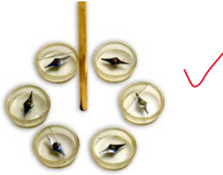
Görsel 2.5: Üzerinden akım geçen düz telin çevresindeki pusula iğnelerinin yönlenmesi
