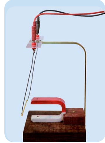
c) Akımın geçme yönüne göre telin mıknatısın dışına doğru itilmesi
