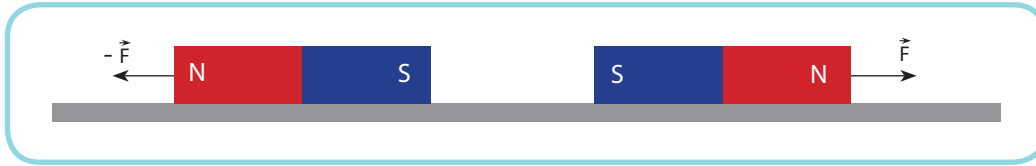
Şekil 2.3: Çubuk mıknatısların birbirine uyguladığı temas gerektirmeyen kuvvetler
