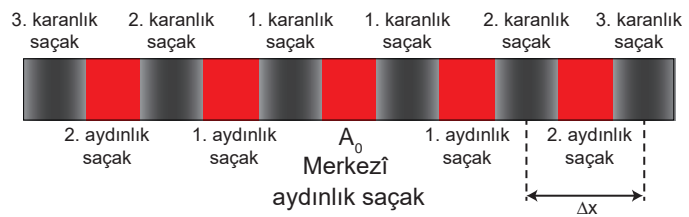
Şekil 3.8: Işığın çift yarıktaki girişim desenindeki saçaklar ve saçak genişliği
